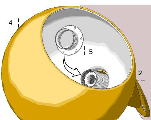
Fissare il diffusore (4) al corpo lampada (2) avvitando la ghiera (5).
