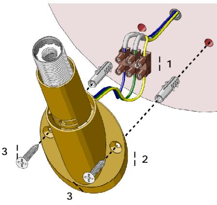
Effettuare i collegamenti elettrici all'apposito morsetto (1) facendo attenzione a posizionare il cavo di terra in prossimità del simbolo . Eseguire i fori a parete e alloggiare il morsetto e i cavi di alimentazione all'interno del corpo lampada (2). Fissare il corpo lampada a parete mediante le viti (3).
